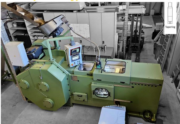
Diese Presse ist für das Einziehen und Kalibrieren von Hülsen aus Stahl oder Messing ausgelegt. Je nach Produktegrösse verfügt sie auch über die Möglichkeit ein Zündloch zu stanzen.
