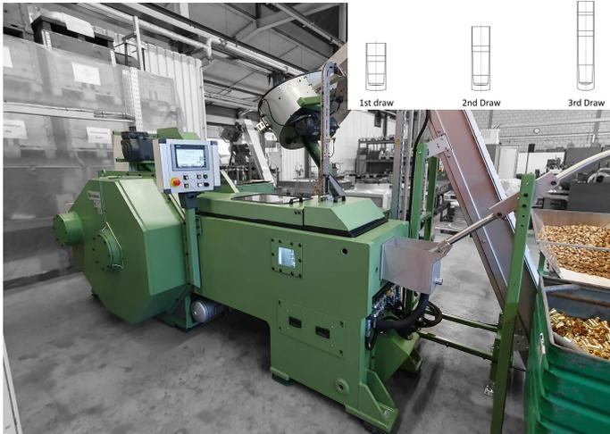
Diese Presse ist für das Abstreckziehen von Hülsen aus Stahl oder Messing ausgelegt.
