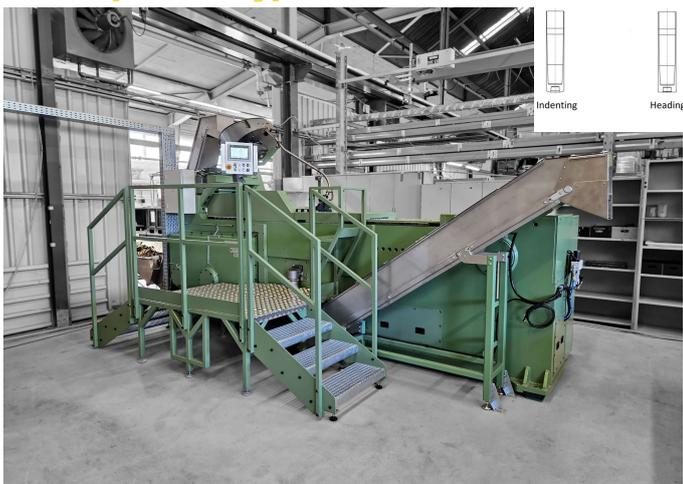
Diese Presse ist für das Bodenpresse von Hülsen aus Stahl oder Messing ausgelegt. Zur Umformung ist sie mit einem einzigartigen Kniehebel für beste Umformergebnisse ausgestattet. Auch andere Vorwärts- oder Rückwärtsfliesspressvorgänge können durchgeführt werden.
