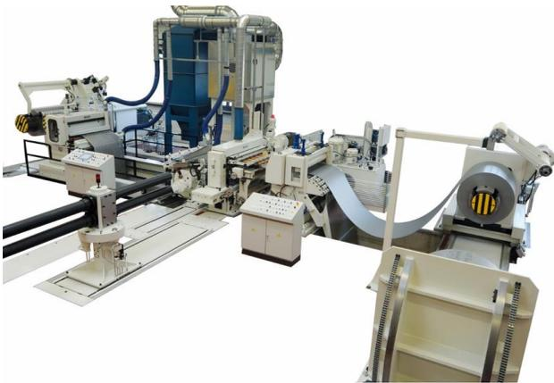
NOBAG ist Ihr Spezialist für fortschrittliche Schnittqualität, schnelles Umrüsten und optimierten Bedienkomfort bei erweiterter Automatisierung. Die Längsteilanlagen sind für Stahl, Aluminium, Nichteisenmetalle und Sonderwerkstoffe konzipiert.
