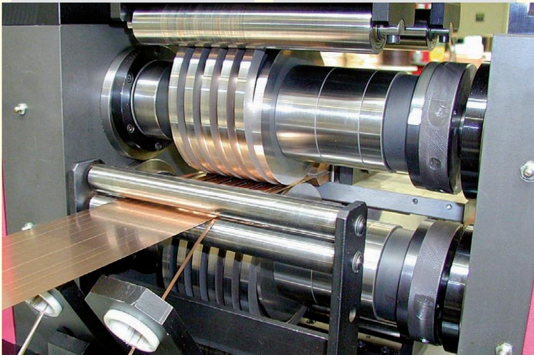
Schneiden mit Excenter-Stahlauswerferringen
