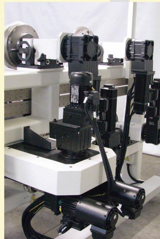
Отдельные приводы с возможностью изменения направления намотки
