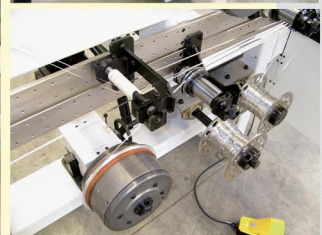
^ Два независимых намотчика для обрезанных кромок пленки ^ Свободно регулируемые направляющие для штрипсов
