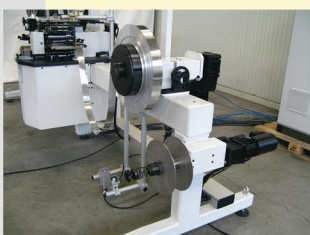
Размотчик рулона для обратной и прямой подачи, включая намотчик для бумаги
