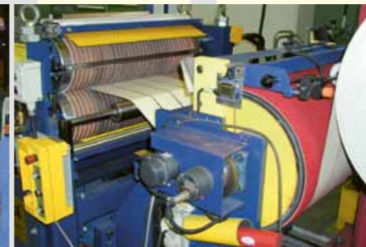
Bandbremsen für delikate Oberflächen Belt tension unit particularly for delicate surfaces
