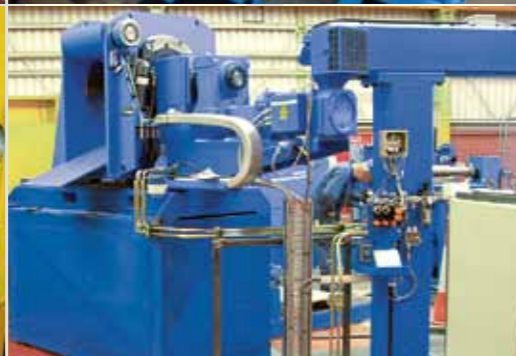
⌘ Abfallschneider mit automatischer Schnittpaltein- stellung für variable Banddicken ^ Abfallbündler ⌘ Scrap cutter with automatic cutter clearance adjustment for variable material thicknesses ^ Scrap bundler
