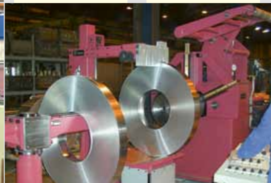
Bundentladeeinheit für Schmalbänder Coil unloading equipment for thin gauge, narrow strips
